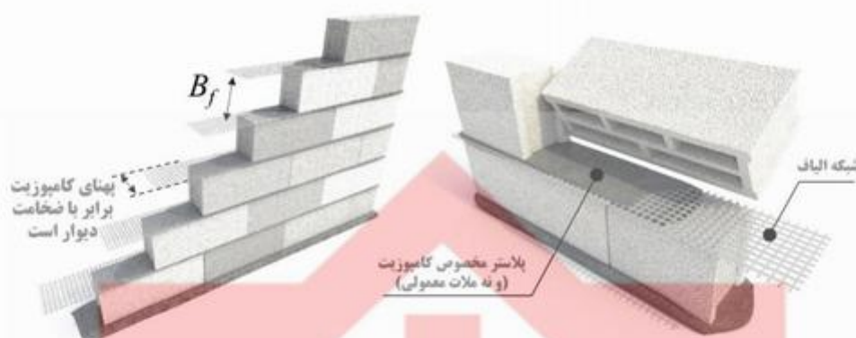
شکل ۳-۳ کمیت‌های مورد نیاز به منظور محاسبه ظرفیت خمش افقی دیوارهای بنایی مسلح به کامپوزیت شبکه الیاف در بند بستر.
